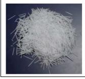
Trockeneis besteht aus fester Kohlensäure (chem. CO2). Trockeneis wird aus flüssiger Kohlensäure hergestellt, die unter Ausnutzung der physikalischen Eigenschaften verfestigt wird. Das reiskornartige Trockeneis (Pellets mit ca. 3mm Durchmesser) hat eine Temperatur von etwa -79 °C. Zur Dosierung werden handelsübliche Schaufeln aus Kunststoff benutzt. Trockeneis ist für den Einsatz in Lebensmitteln zugelassen, ungiftig, geruchlos und geschmacksneutral und dadurch hygienisch unkritisch.
